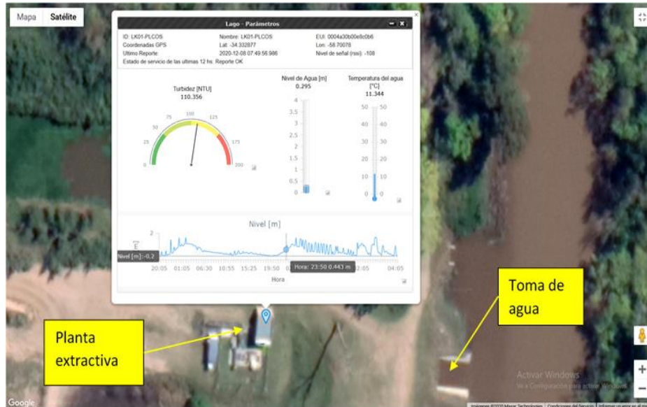
Figura 6: Explosión de datos de nivel, temperatura y turbidez de un río. En la imagen se observa la planta de extracción y la toma respectiva. Importante es destacar el gráfico que presenta la evolución del nivel del río. Estos dispositivos se reportan vía LoRa .
